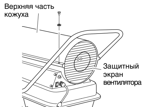
Рис. 8. Снятие верхней части кожуха, нагревателя мощностью 29 и 44 кВт
