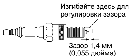
Рис. 12. Регулировка зазора свечи зажигания, нагреватель мощностью 10 кВт
