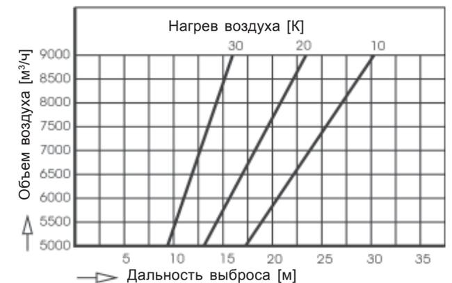
Пример: LH 100 с жалюзи;  $\Delta t_L = t_{L_{\text{Aeff}}} - t_{\text{Raum}} = 20 \text{ K}$ ; объём воздуха = 7 300 м³/ч
