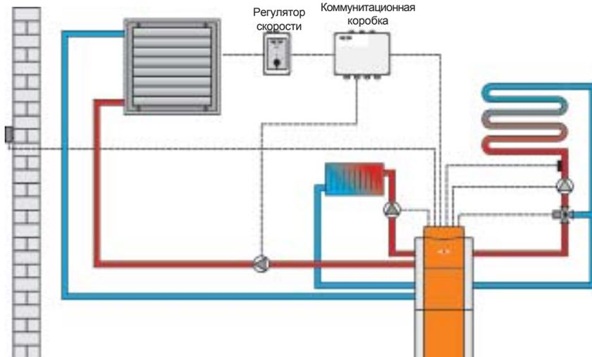
Предназначена для устройства LH в сочетании с отопительным котлом фирмы WOLF:
