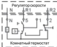
В корпусе из пластмассы 75 x 75 x 25 мм для монтажа поверх штукатурки. Коммутационная способность в режиме нагрева 10(4) А, охлаждения 5(2) А при 230 В / 50 Гц, термическая обратная связь.
