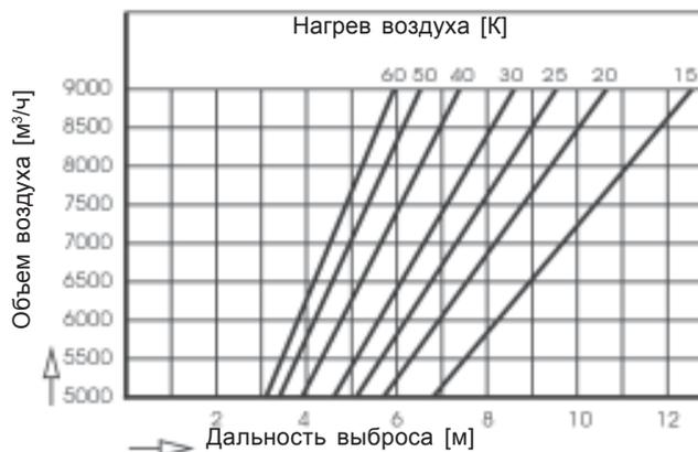
Пример: LH 100 с жалюзи;  $\Delta t_L = t_{L,eff} - t_{Raum} = 20$  K; объем воздуха = 7 750 м³/ч
