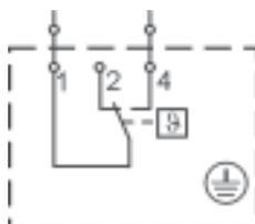
При понижении температуры ниже установленного значения, термостат защиты от замерзания отключает тепловентилятор LH, благодаря этому удается избежать размораживания теплообменника. При повышении температуры выходящего воздуха калорифер LH снова включается в рабочий режим. Термостат защиты от замерзания нужно последовательно соединять с термоконтактами
