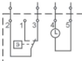
В корпусе из пластмассы 162 x 80 x 44 мм для монтажа на вставном цоколе, со снижением температуры в ночное время суток, с программой переключения на сутки или на неделю (можно выбирать программу), температуру на дневное или на ночное время суток можно устанавливать отдельно.
