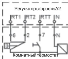
В корпусе из пластмассы 125 x 75 x 25 мм для монтажа поверх штукатурки. В сочетании с регулятором скорости А2, подходит для автоматического 2-ступенчатого режима вентилятора LH.
