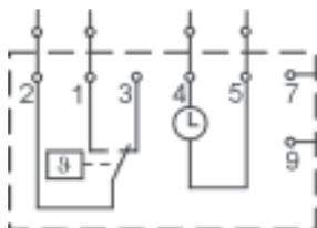
В корпусе из пластмассы 162x80x44 мм для монтажа на вставном цоколе, со снижением температуры в ночное время суток, с программой переключения на сутки или на неделю (можно выбрать программу), температуру на дневное или на ночное время суток можно устанавливать отдельно.
