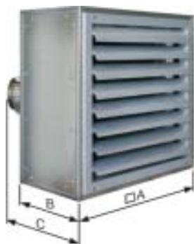
Конструкция в виде профильной рамы из сварных оцинкованных стальных угловых профилей. Облицовка из оцинкованных стальных листов. задняя стенка выполнена с глубоко натянутым впускным соплом. Выпускные жалюзи с регулируемами пластинами для направления воздуха.
