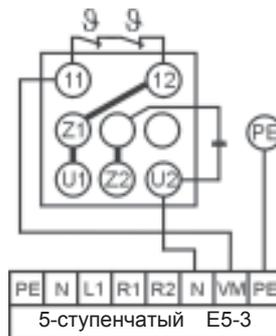
Термоконтакты в управляющем контуре
