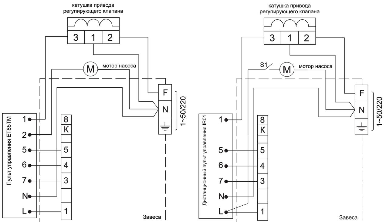
Выключатель S1 устанавливается пользователем.
