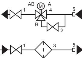
Схема смесительного узла при  $\Delta P < 40$  кПа
