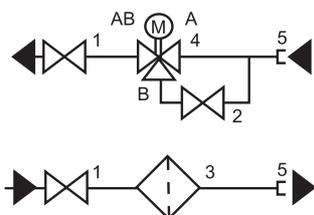
Схема смесительного узла при  $\Delta P < 40$  кПа
