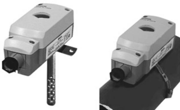
Термостаты защиты от замерзания предназначены для сигнализации при уменьшении температуры воды в обратном трубопроводе ниже +5°C. При этом вентиляторы завесы должны быть выключены, для чего необходимо подключить завесу через контакты термостата.
