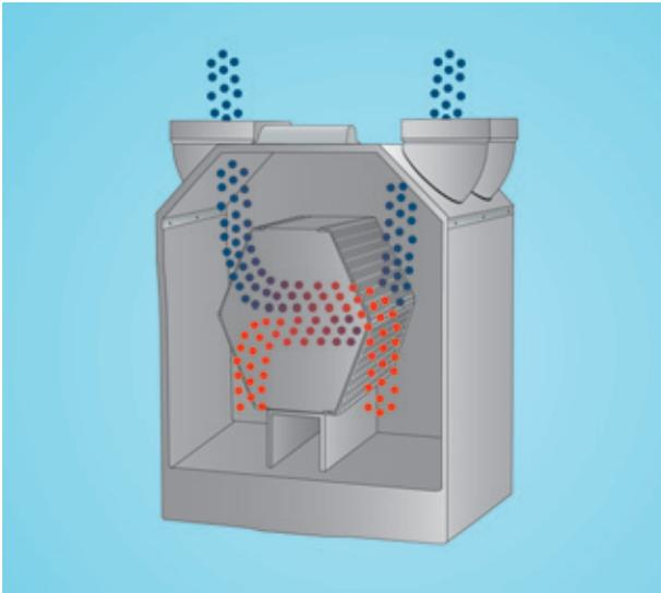
**Рекуперация тепловой энергии.** Вентиляционные системы Zehnder снабжены теплообменниками, работающими по принципу перекрестного противотока. Они передают часть тепловой энергии отработанного воздуха свежему воздуху. Теплопередача осуществляется через тонкие плиты из синтетического материала. На режимах без замерзания конденсата коэффициент рекуперации тепла составляет около 90 %, что позволяет снизить расходы на отопление почти на 40 %.
