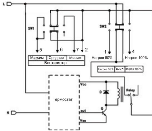
Электрическая схема пультов управления и коммутации ПКУ-Е и ПКУ-В
