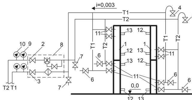
На рисунке вертикальная двусторонняя завеса 1 из четырех секций подключена к отопительной сети через смесительный узел 8.
