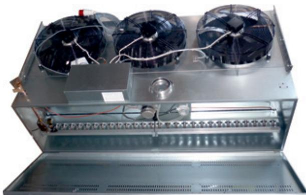
В завесах серии 700 в качестве газовых источников тепла используются 4-ходовые теплообменники, выполненные из бесшовных труб. Материалом для теплообменников служит конструкционная сталь с внутренним и наружным алюминиевым покрытием. Толщина стенки теплообменника составляет 2 мм. Температура газов внутри трубы достигает 400 °С. Продукты сгорания выводятся по дымоходу на улицу. Завесы могут защищать проемы высотой до 7 метров.
