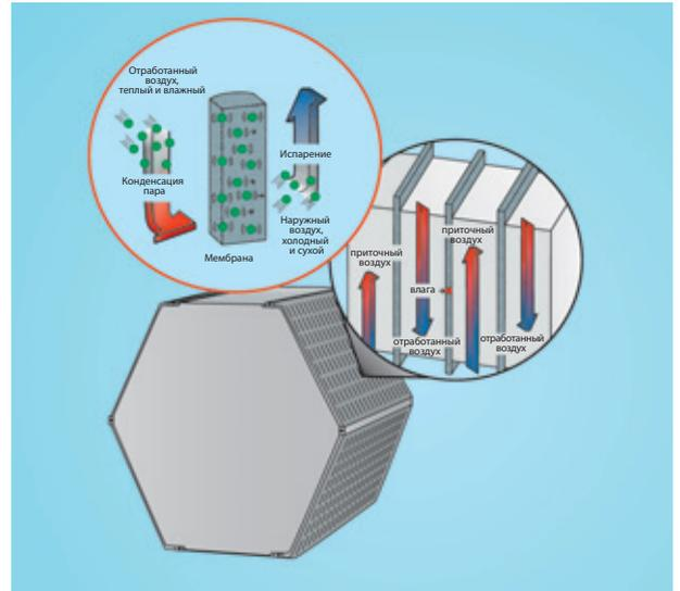
**Рекуперация влажности.** С помощью пластинчатого энтальпийного теплообменника в здании поддерживается оптимальный уровень влажности. Это особенно важно в зимнее время, когда комнатный воздух становится более сухим. Водяной пар «конденсируется» из влажного отработанного воздуха и впитывается мембраной. Полученная влага и тепло передаются приточному воздуху, при этом предотвращается передача микробов и неприятных запахов.
