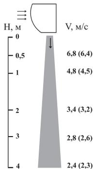
Завесы серии 300 предназначены для защиты проемов высотой от 2,0 м до 3,5 м в офисных, торговых, складских помещениях, а также в зданиях культурно-бытового назначения.
