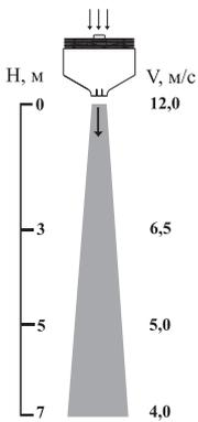
Завесы серии 700 являются наиболее мощными из представленных на российском рынке обычных компактных воздушно-тепловых завес с водяным источником тепла. Завесы могут защищать проемы высотой до 7,0 м.
