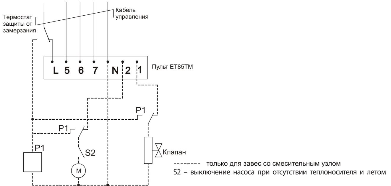
**Рис .8. Схема подключения термостата защиты от замерзания (для серий 500, 700, 800).**
