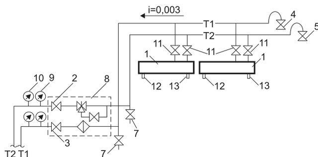
После заполнения системы теплоносителем необходимо посредством кранов 4, 5 удалить воздух из системы и воздушно-тепловых завес.
