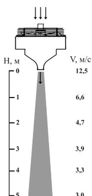
Завесы серии 400 с повышенной коррозионной стойкостью предназначены для защиты дверей и ворот высотой от 3,0 м до 5,0 м в помещениях с атмосферой, содержащей капельную влагу, в частности, в автомойках.
