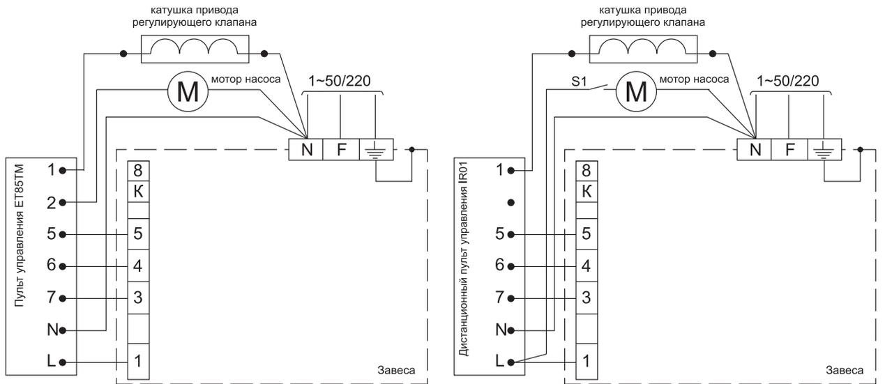
Выключатель S1 устанавливается пользователем.
