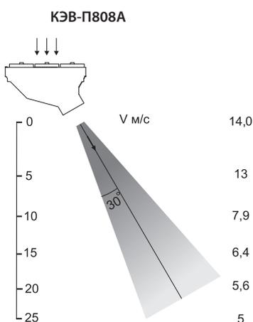
Завесы серии 800 являются супермощными. Они не имеют аналогов ни в России, ни за рубежом. Удельный расход воздуха на метр размаха струи лежит в диапазоне от 12000 до 37000 м<sup>3</sup>/ч/м. Такими завесами можно защитить проемы высотой от 6 до 12 м, предназначенные для спецтехники, например, в самолетных и вертолетных ангарах.
