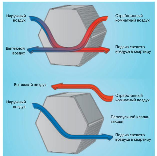
**Летний перепускной клапан.** Большинство вентиляционных систем Zehnder снабжены летним перепускным клапаном. Его задача – проводить отработанный воздух мимо теплообменника. Это позволяет избежать ситуации, когда охлажденный холодильным агрегатом летний приточный воздух подогревается теплым отработанным воздухом. Эта функция может оказаться полезной и в прохладную летнюю ночь.
