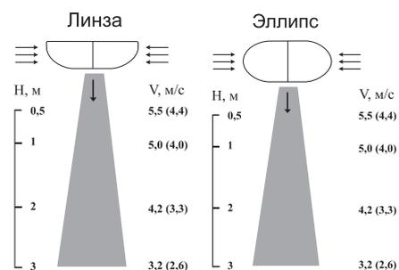
Завесы серии 600 выпускаются в форме установленных вертикально колонн и подвешиваемых горизонтально к потолку эллиптических и сегментных тел со специальной подсветкой. Высота/ширина установки до 3,5 м.
