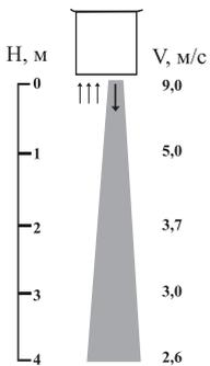
Завесы серии 300 устанавливаются в офисных помещениях с высотой проема до 3,5 м.
